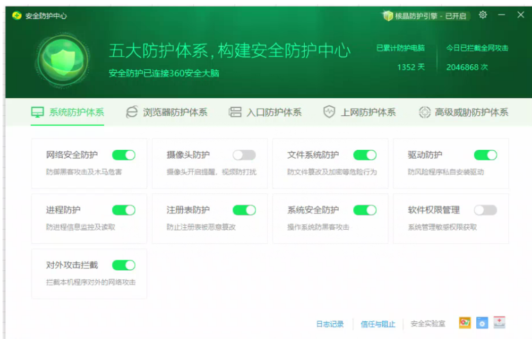
图：360安全防护中心——关闭"注册表防护""软件权限管理"等选项
